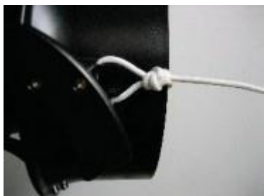
Fissaggio della fune alla maniglia sx
