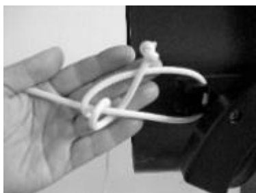
Fissaggio della fune alla maniglia sx
